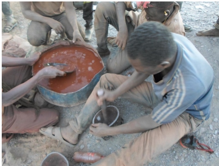
Photo 3: Processus artisanal de broyage et de traitement humide de minerai d'or
