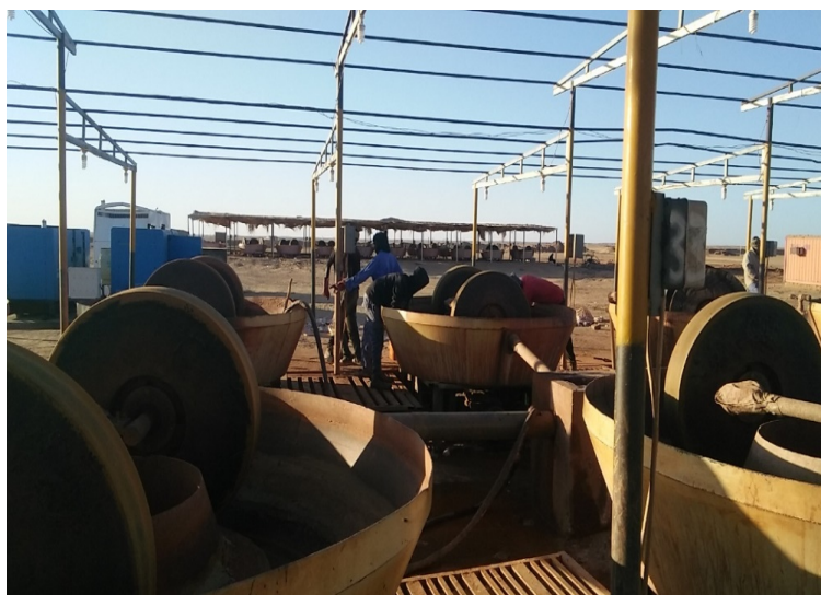
Photo 1 : Unité mécanisée de traitement de minerai d'or d'une EMAP
