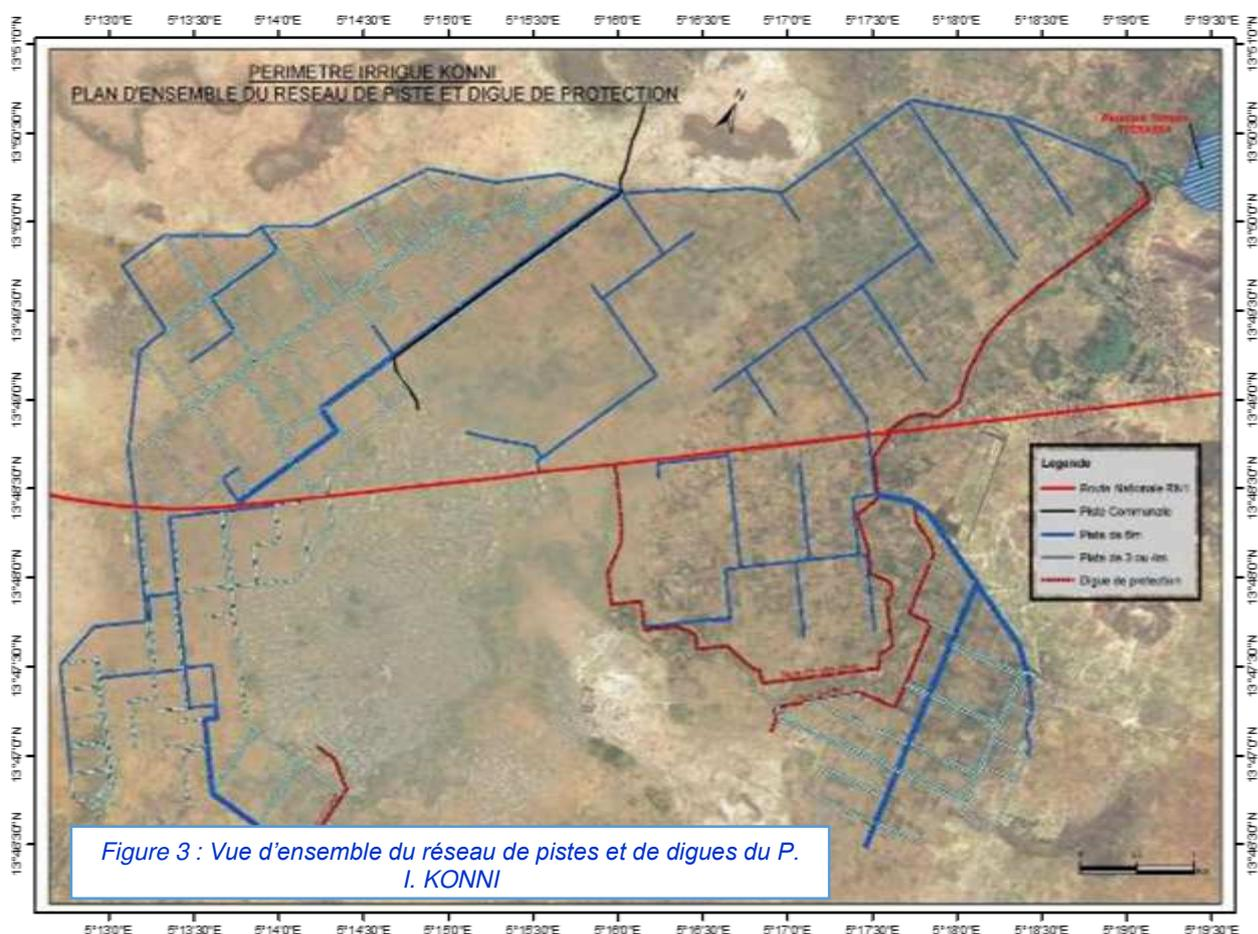
Figure 3 : Vue d'ensemble du réseau de pistes et de digues de protection du P. I. KONNI
